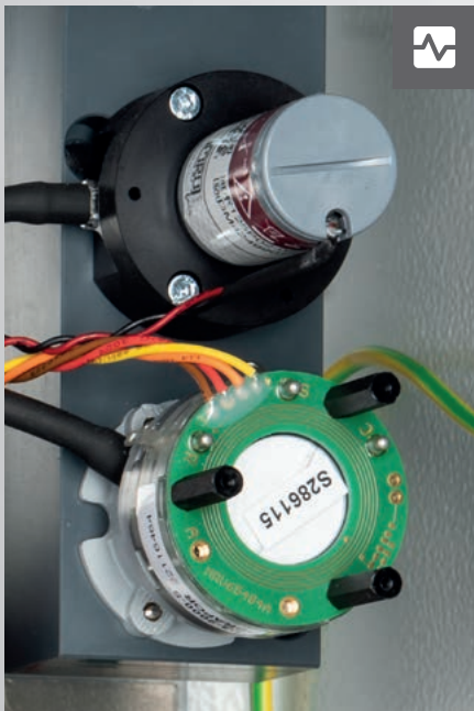
Elektrochemische Sensoren für \text{H}_2\text{S} - und \text{O}_2 -Messungen
