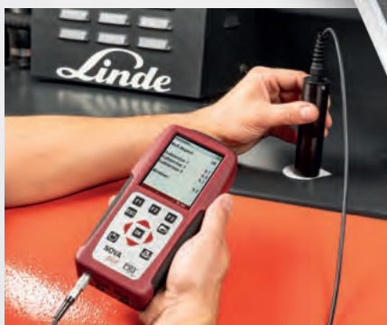
Zur Bestimmung der Schwärzungszahl (Bosch-Rußzahl) verfügt das NOVAplus FFZ über einen Densitometer, mit dem die Rußzahl punktgenau ermittelt wird.
