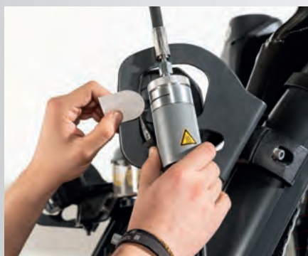
Kondensatbildung bei der Rußmessung wird durch Beheizung verhindert. Das erforderliche Abgasvolumen wird durch eine Regelung der Gaspumpe gewährleistet.
